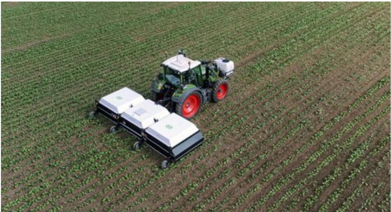
L'une des machines d'Ecorobotix, équipée de caméras repérant chaque mauvaise herbe. — © Ecorobotix
